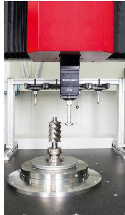
Luftlagerführungselemente in allen Achsen für einen verschleißfreien, leichtgängigen Betrieb
