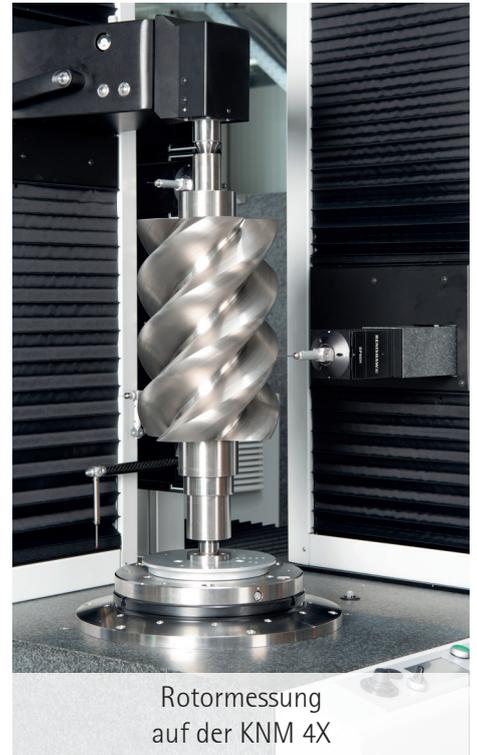
Rotormessung auf der KNM 4X
