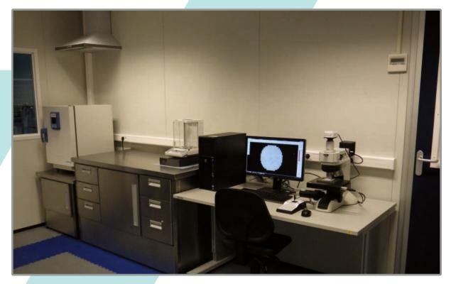
Komplettes Reinraumlabor, entworfen und geliefert an Mitsubishi Turbochargers and Engine Europe, Almere, Niederlande. Spülvorrichtung, Partikelzählsystem, Instrumente und Möbel aus Edelstahl
